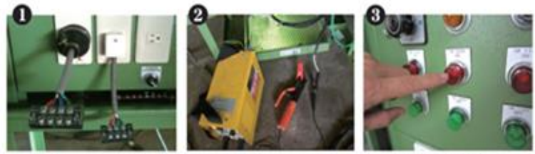
1. 接上適用電源 2. 測試線接線完成 *防電擊測試, 外殼不用接地 3. 送入電源
